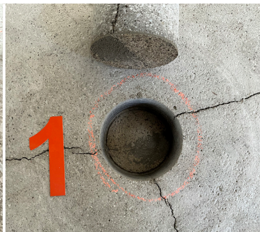
Bohrkernentnahme im Rissbereich
