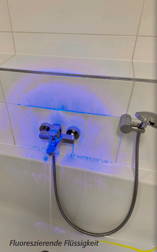
Offene Fugen bei hohlliegenden Fliesen
